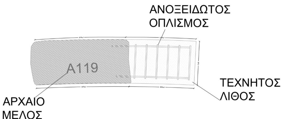
Σχέδιο 1-Κατασκευαστική λεπτομέρεια τεχνητού λίθου σε κάτοψη
